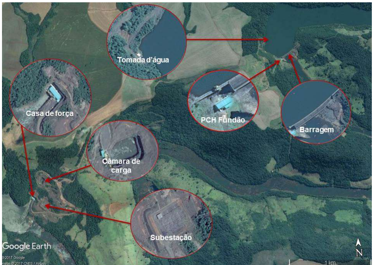
FIGURA 1.1 LOCALIZAÇÃO DAS ESTRUTURAS DA UHE FUNDÃO
